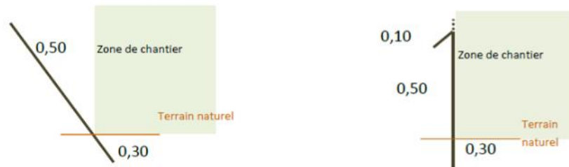
Figure 164 : Principe et caractéristique des clôtures contre l'intrusion des batraciens
